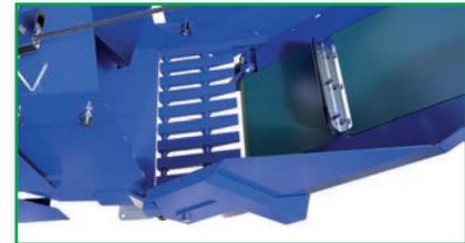
Zwischen dem Spaltmesser und dem Förderband befindet sich ein Gitter, durch welches die Sägespäne fallen.
