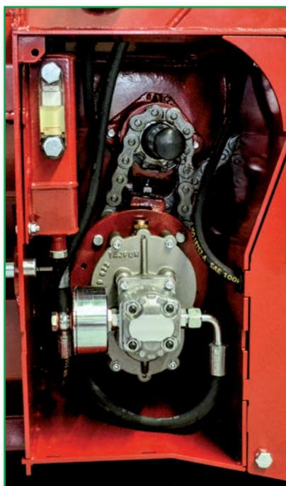
Antrieb der Hydraulikpumpe mit Getriebe
