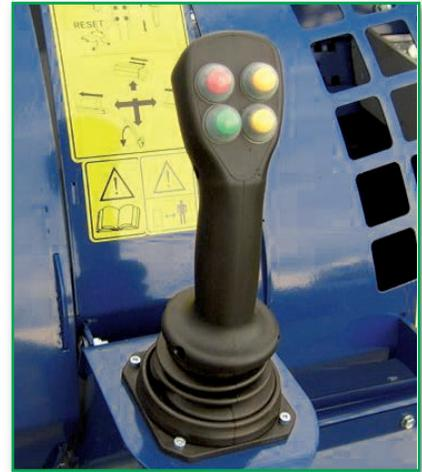
Der Joystick sorgt für eine einfache Bedienung des Säge-Spaltautomaten
