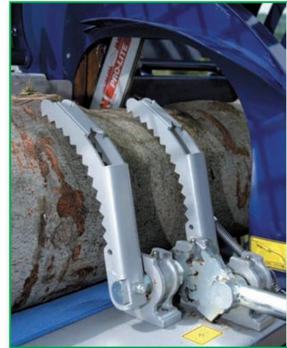
Durch den Niederhalter (Druckhebel) wird das Drehen des Holzes verhindert und der Stamm kann in einer sicheren Lage gehalten werden, so dass auch das letzte Stück des Stammes richtig in den Spaltkanal fällt.
