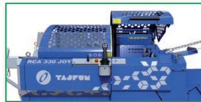
Durch das Öffnen der Schutzhaube sind alle Maschinenfunktionen außer Betrieb.
