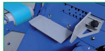
Eine Nockenplatte, die während des Sägens in waagerechter Position bleibt, sorgt für sicheres und richtiges Hinabfallen des Holzes.
