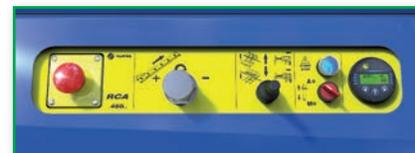
Display mit Maschinenangaben-Anzeige wie Zapfwellendrehzahl, Arbeitsstunden, Arbeitsdrücke, Temperatur des Hydrauliköls, usw. Zusätzlich kann die automatische Messernivellierung eingestellt werden. (RCA 480 Joy PLUS)
