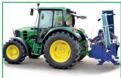
Transportposition. Das Vorschubband, das Förderband und auch der Hebetisch können aufgeklappt werden. Der RCA kann an die Dreipunkt-Aufhängung des Schleppers angebaut werden.
