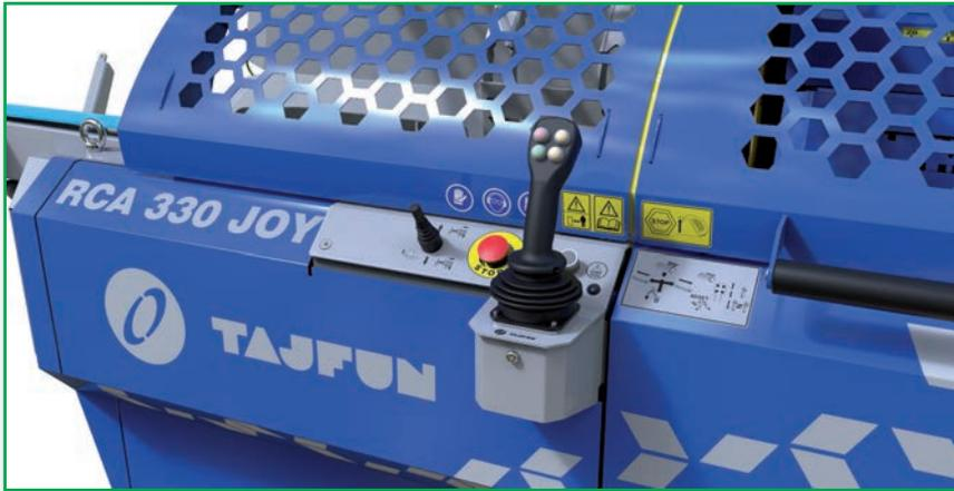
Ergonomische, sichere und einfache Bedienung von allen Grundfunktionen des RCAs (Vorschub links-rechts, Sägen, Spalten, Heben und Senken des Spaltmessers...) mit dem Joystick
