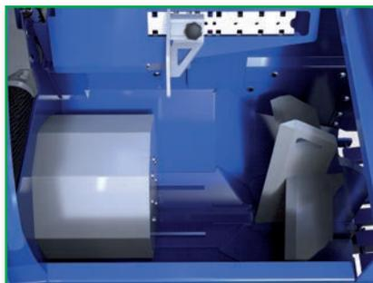
Spaltzylinder mit 25 to Spaltkraft – 2 Spaltgeschwindigkeiten, automatische Umschaltung
