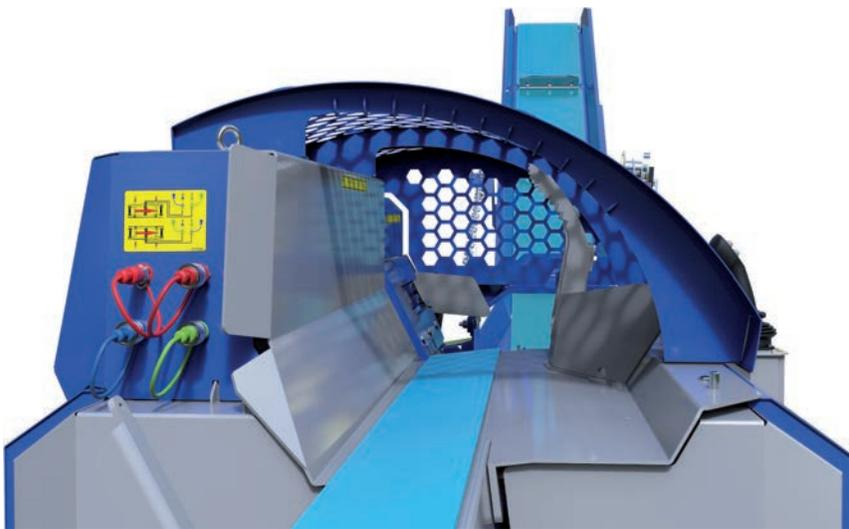
Vor dem hydraulischen Niederhalter gibt es eine Führungsleiste, die den Stamm führt und dessen Stossen gegen den Halter verhindert. Durch den hydraulischen Niederhalter wird das Drehen des Holzes verhindert.
