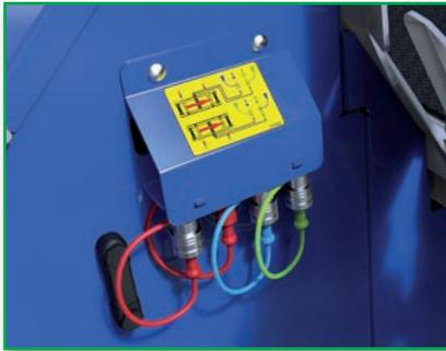
Hydraulischer Ausgang für das RCA-Zubehör wie z.B. Längs- und Quersförderer RN 5000 S / RN 5000 M)
