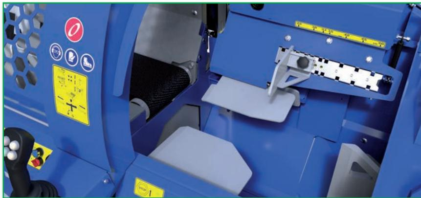
Der hydraulische Längenbegrenzer ist von 25 - 50 cm verstellbar. Der Begrenzer kommt bei jedem Vorschub etwa 5 cm gegen den Stamm und beim Auslösen des Vorschubes wieder zurück in die Ausgangsposition. Zwei Nockenplatten öffnen selbständig und sorgen für sicheres und richtiges Hinabfallen des Holzes.
