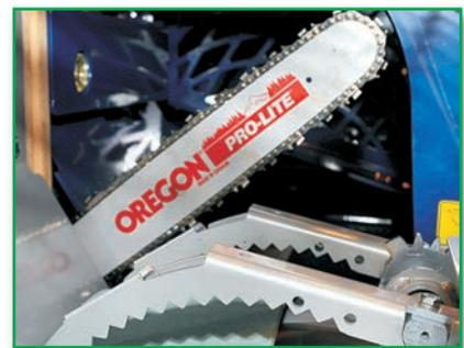
Die Kettensäge ermöglicht ein sicheres und schnelles Schneiden des Holzes, sowie eine einfache und problemlose Wartung. Die Sägekette bleibt stehen, wenn nicht gesägt wird (mit Hilfe einer Kupplung).
