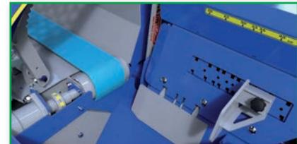
Hydraulischer Längenbegrenzer ist von 20 bis 40 cm verstellbar. Der Begrenzer kommt bei jedem Vorschub etwa 4 cm gegen den Stamm und beim Auslösen des Vorschubes wieder zurück in die Ausgangsposition, damit das durchgesägte Holzstück sicher in den Spaltkanal fällt.
