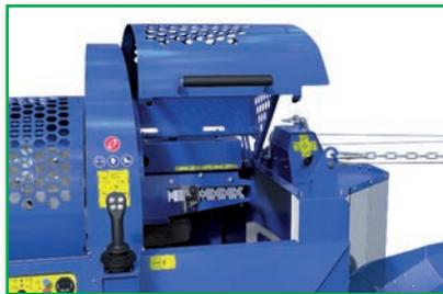
Durch das Öffnen der Schutzhaube sind alle Maschinenfunktionen außer Betrieb.
