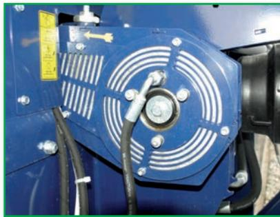
Durch eine Kupplung schaltet die Sägekette automatisch zu und ab.
