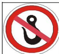
Interdiction de travailler avec un crochet: Travailler avec un crochet n'est permis que sur grues spécialement équipées à cette fin!
