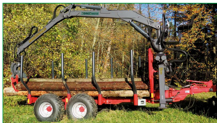
RW 10 , sehr stabil gebaut mit robusten Zentralrohrrahmen. Grosse Wendigkeit durch Deichsellenkung.
