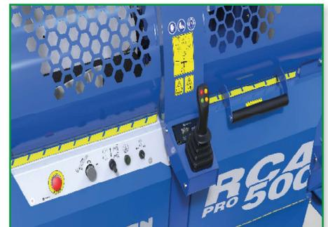
Joystick: Er ermöglicht eine ergonomische, sichere und einfache Steuerung der Hauptfunktionen der Maschine (Starten der Maschine, Vor- und Rückwärtsfahren, Sägen, Öffnen der Streuklappen während des letzten Viertels des Holzes, Spalten, Unterbrechung des Spaltens, Anheben/Absenken des Klingen).
