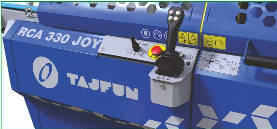
Ergonomische, sichere und einfache Bedienung von allen Grundfunktionen des RCAs (Vorschub links-rechts, Sägen, Spalten, Heben und Senken des Spaltmessers....) mit dem Joystick.
