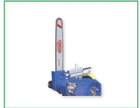
Kettensäge mit enormer Schnittgeschwindigkeit 25m/s (12000 U/min).
