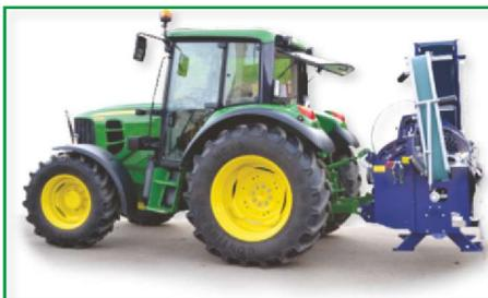
Transportposition. Das Vorschubband, das Förderband und auch der Hebetisch können aufgeklappt werden. Der RCA kann an die Dreipunkt-Aufhängung des Schleppers angebaut werden.
