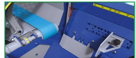
Hydraulischer Längenbegrenzer ist von 20 bis 40 cm verstellbar. Der Begrenzer kommt bei jedem Vorschub etwa 4 cm gegen den Stamm und beim Auslösen des Vorschubes wieder zurück in die Ausgangsposition, damit das durchgesägte Holzstück sicher in den Spaltkanal fällt.
