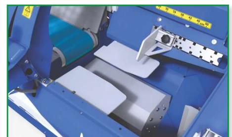
Zwei Nockenplatten, die während des Sägens in waagerechter Position bleiben, sorgen für sicheres und richtiges Hinabfallen des Holzes.
