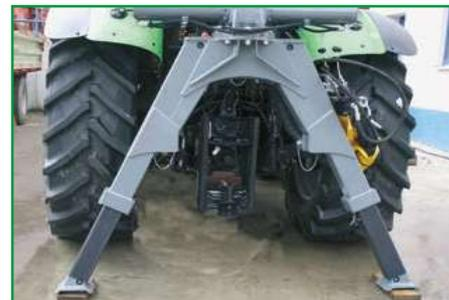
Stützbein für Wagenanhängung direkt am Schlepper.
