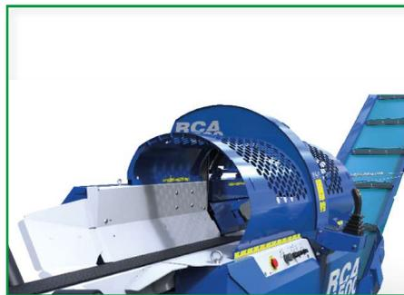
Vor dem hydraulischen Stammsperrarm ist eine Führung positioniert, die den Stamm während seines Durchgangs durch den Schutz zum Schnittpunkt führt. Der hydraulische Stammhaltearm drückt den Stamm beim Sägen und schützt ihn vor dem Drehen und Wenden.
