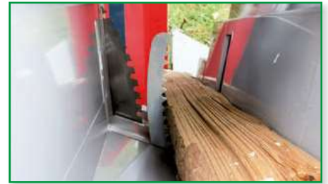
Niederhalter für Fixierung des Holzes.
