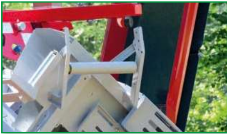
Bedienrolle an der Wippe verstellbar.
