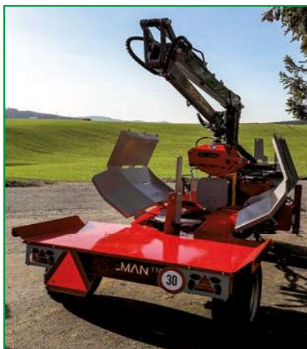
2-Schicht-Lackierung: Zinkgrundierung + zusätzlich pulverbeschichtet
