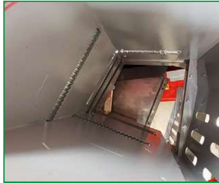
Rollen für optimales Nachrutschen des Holzes
