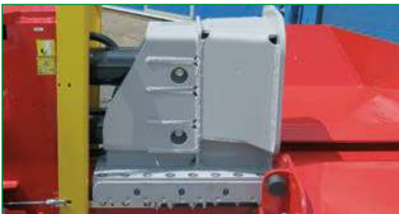
Grosse hochwertige Führung mit Schmiernippel
