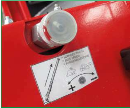
Geschwindigkeitsverstellung des Förderbands
