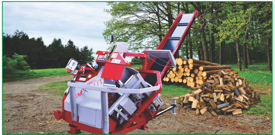
Rollen für optimales Nachrutschen des Holzes
