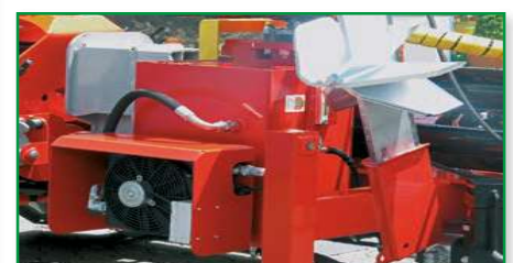
Ölkühler mit Spaltkreuzhalterung
