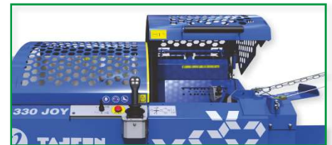
Durch das Öffnen der Schutzhaube sind alle Maschinenfunktionen ausser Betrieb.
