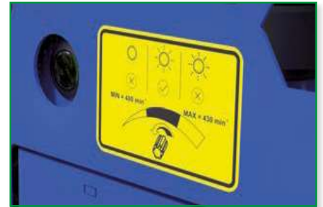
Das Licht gibt an, ob die richtige Zapfwellenzahl eingestellt ist. Aus = unzureichende Drehzahl An = richtige Drehzahl Blinken = überhöhte Drehzahl (RCA 480 Joy plus)
