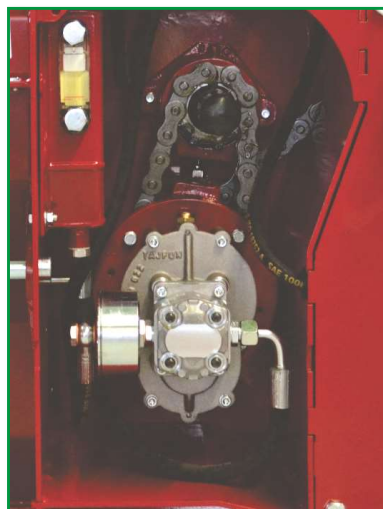
Antrieb der Hydraulikpumpe mit Getriebe
