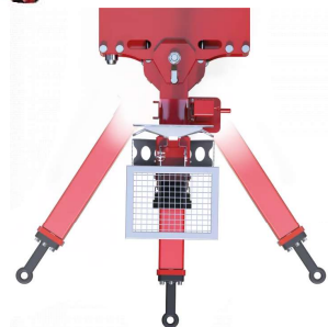
Zwei Hydraulikzylinder und Winkel für Schwenkdeichsel +/- 30°
