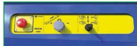
Links befindet sich der Not-Aus-Schalter. Über den Drehknopf in der Mitte wird die Geschwindigkeit des Förderbandes eingestellt und mit dem rechten Schalter lassen sich die Anbaugeräte bedienen (RCA 480 Joy)
