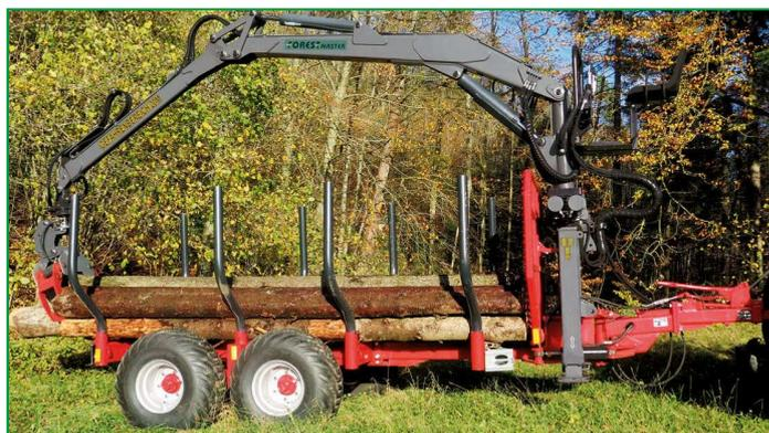
**RW 10**, sehr stabil gebaut mit robusten Zentralrohrrahmen. Grosse Wendigkeit durch Deichselenkung.
