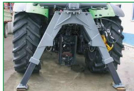
Stützbein für Wagenanhängung direkt am Schlepper.
