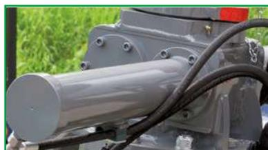
Schwenkgehäuse aus Stahl mit Verstärkung auch mit 4 Schwenkzylinder möglich.
